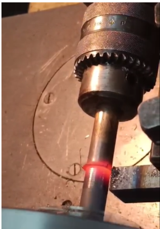
Рисунок 3 - Нагрев деталей трением (а), соединение разнородных металлов после проковки (б)
