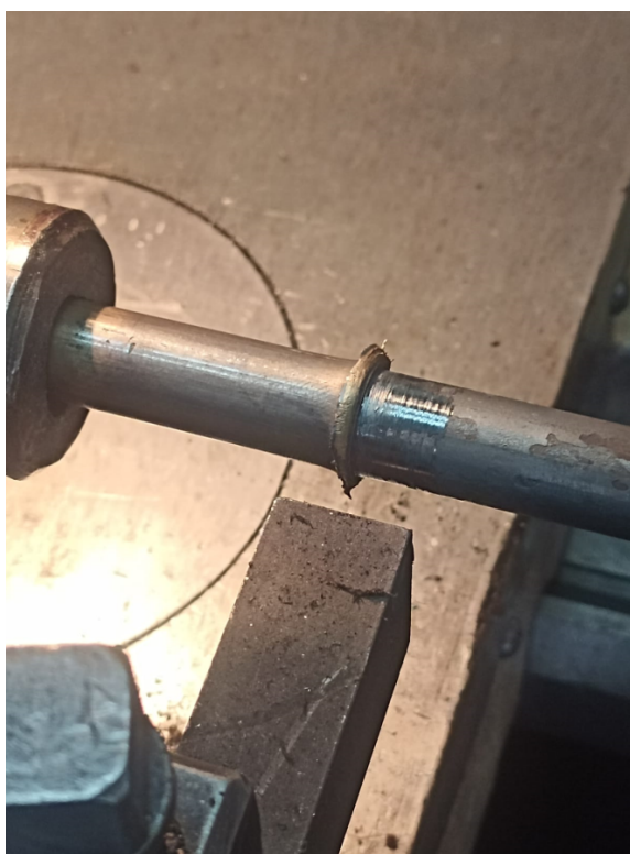
Рисунок 3 - Нагрев деталей трением (а), соединение разнородных металлов после проковки (б)
