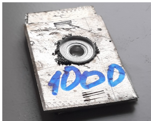
Рис. 3. Сварные соединения пластин при глубине погружения инструмента 2 мм а - толщиной 1,5 мм, диаметр 22 мм, скорости вращения 580 и 1000 об/мин; б – толщиной 2,5 мм, диаметр 14 мм, скорость вращения 1000 об/мин.
