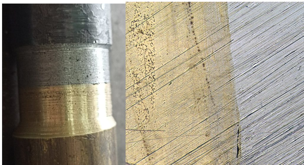
Рисунок 4 - Соединение разнородных металлов после сварки трением и обработки точением (а), макрошлиф сварного соединения (б)
