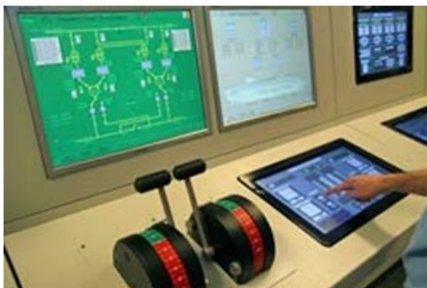
Рисунки 8 и 9 — Портативная консоль управления двигателем с мультисенсорными панелями. Типичный пример изображения экрана с панели мультитач [3]
