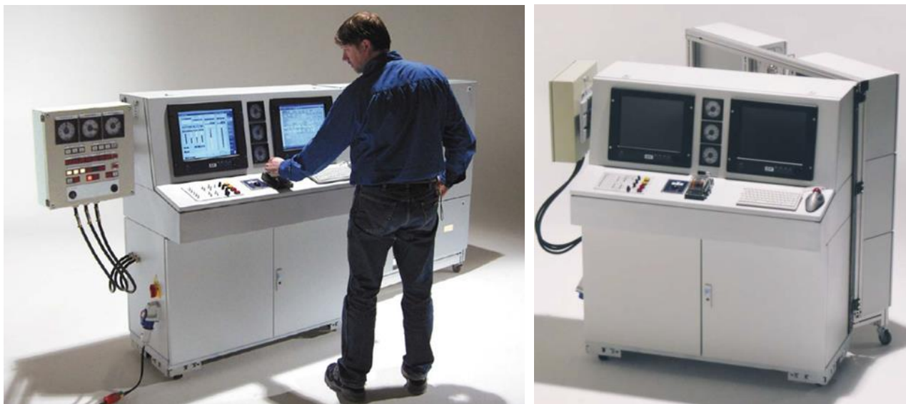
Рисунки 6 – 7 — Портативный тренажер управления дизелем серии ME от MAN B&W Diesel (фото из журнала Diesel Fact [2])
