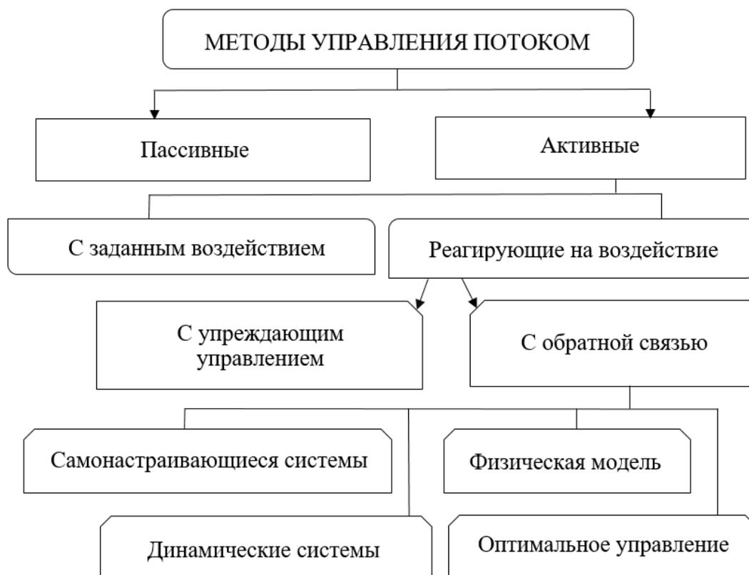
Рис. 1. Схема, иллюстрирующая иерархию управления турбулентным сдвиговым потоком
