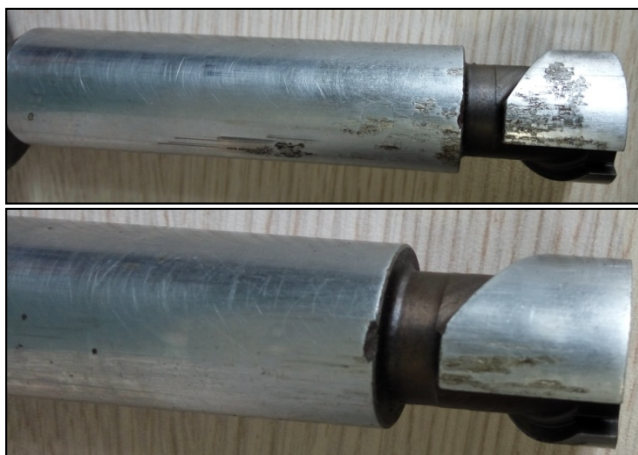
Рис. 3. Следы задира плунжера
