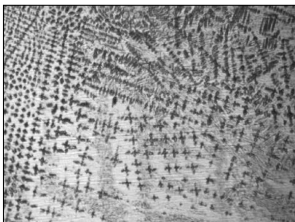
Рис. 7. Микроструктура участка формирования белой фазы, \times 500
