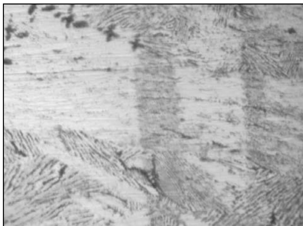
Рис. 8. Микроструктура участка белой фазы, \times 1000
