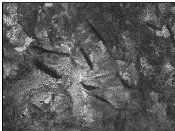
Рис. 2. Микроструктура металлической основы (образец № 5), ×500
