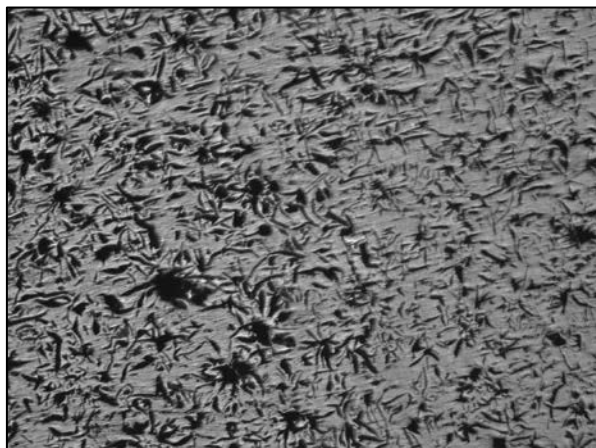
Рис. 1. Форма графита (образец № 7), ×100
