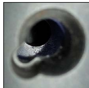
Рис. 2. Износ окон втулки ТНВД
