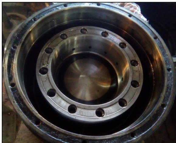
Рис. 5. Следы побежалости на охлаждаемой полости головки поршня
