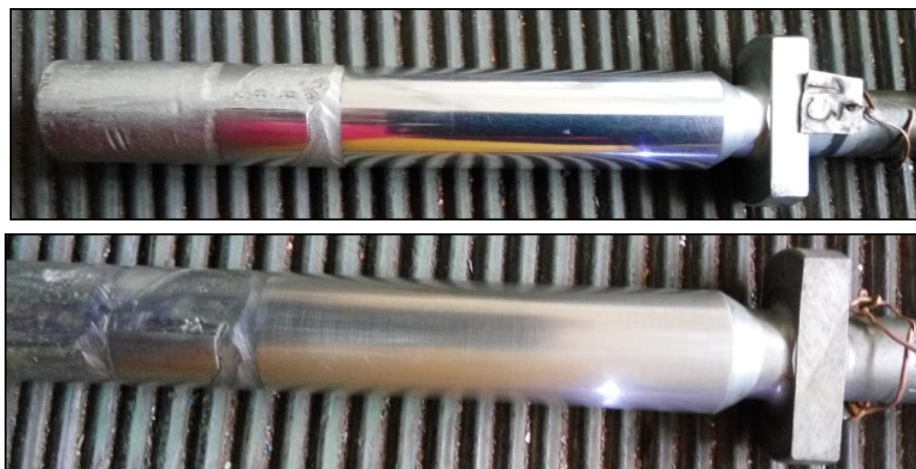
Рис. 6. Общий вид восстановленного плунжера
