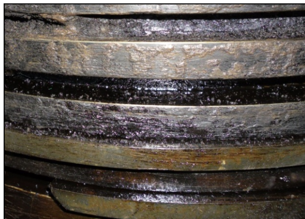
Рис. 4. Закоксовка поршневых канавок
