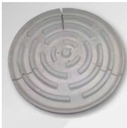
Рис. 12. Керамическое основание кипятивника насоса НВДМ-100
