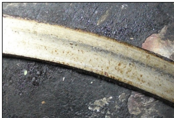
Рис. 16. Кольцевая выработка поршневого кольца по радиальной ширине
