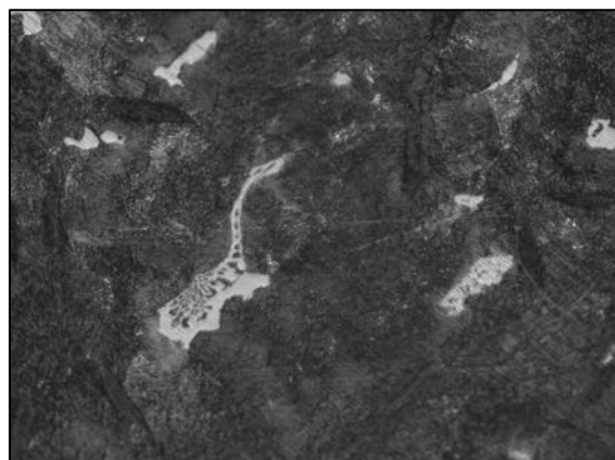
Рис. 7. Включения ледебурита и фосфидной эвтектики (образец № 8), ×500
